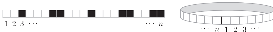
図 12.1 左：セルの配置。右：両端のセルはつながっていると考える。
